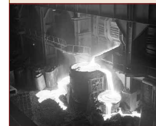
Open hearth furnace pour.
